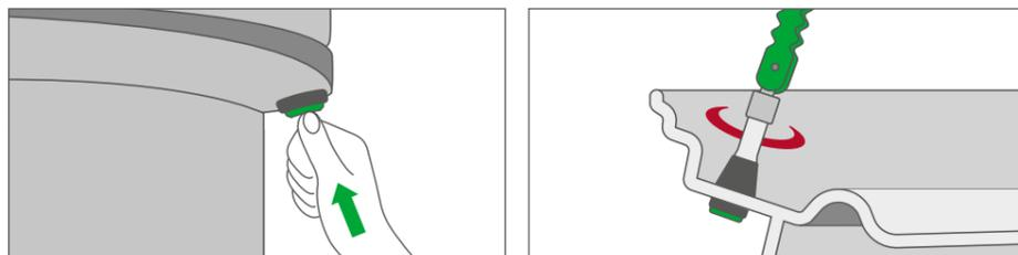
Das Ventil mit wenig Kraftaufwand von Hand eindrücken. Oder mit dem ALLIGATOR Standardeinziehhebel behutsam montieren. Einziehen des Ventils muss in axialer Richtung zum Felgenloch erfolgen - nicht verkanten.
