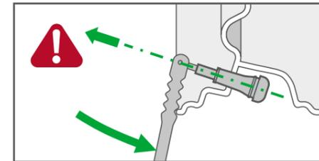
Das Ventil axial ohne Abwinkelung einziehen. Nicht verkanten oder überdehnen.
