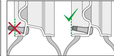
Das Felgenventil darf nicht über die Felgenaußenkante hinausragen.
