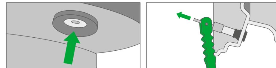
Jetzt kann das Ventil einfach mit dem ALLIGATOR Standardeinziehhebel nach Außen durch das Ventilloch gezogen werden.
