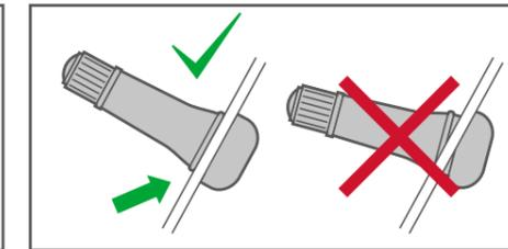
Auf guten Ventilsitz in der Felge achten und das Ventil auf Beschädigungen kontrollieren.
