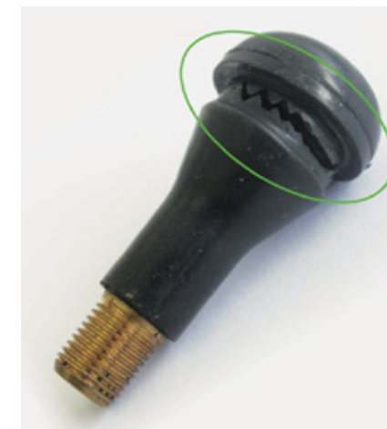
Überaltertes, abgerissenes Ventil
