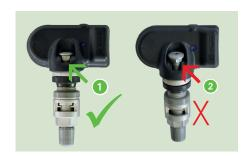
Die Schraube muss soweit vormontiert sein, dass sie sich nicht mehr beim Rotieren des Ventils im Gehäuse verdrehen kann.
