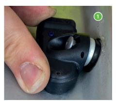
Nicht kompletter Freiraum des verstellbaren Winkels kann bedeuten, dass die Dichtung nicht korrekt an der Felge anliegt und zu Undichtheit führt. 2 Im Extremfall kann das Gehäuse durch die Kräfte der Schraube brechen, wenn der Winkel zwischen Felge und Gehäuse zu stark abweicht. 3
