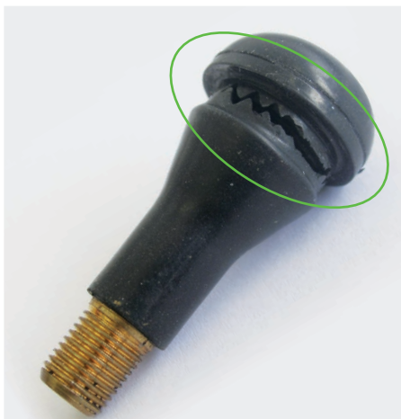
Überaltetes, abgerissenes Ventil
