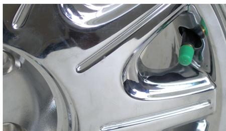
Ein starker Trend im Reifenmarkt ist die Stickstoffbefüllung der Reifen. Für die leichte Kennzeichnung hat ALLIGATOR **grüne Ventilkappen mit Dichtung** im Lieferprogramm.
